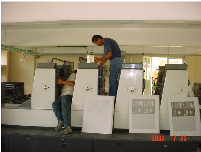
Imagen 26. Ensamblaje de la Imprenta Komori de cuatro selecciones en las nuevas instalaciones de la Editora. Archivo personal del señor Ismael Valencia Toral.
