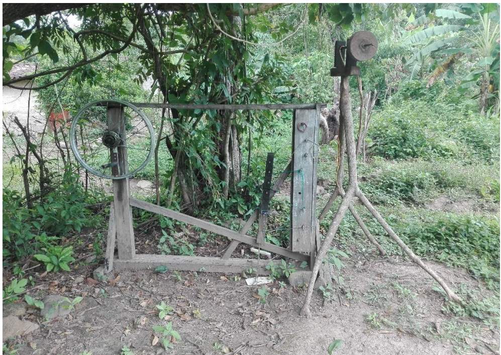
Ilustración 6. Torno donde se realizan los lazos para la elaboración de hamacas
