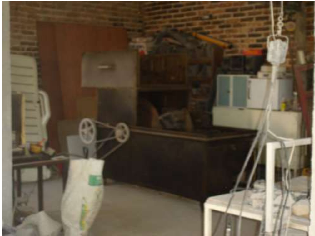
Fig. 57. Cortadora de lajas de obsidiana en el taller de Don Alfredo. La tecnología es traída de Teotihuacán.
