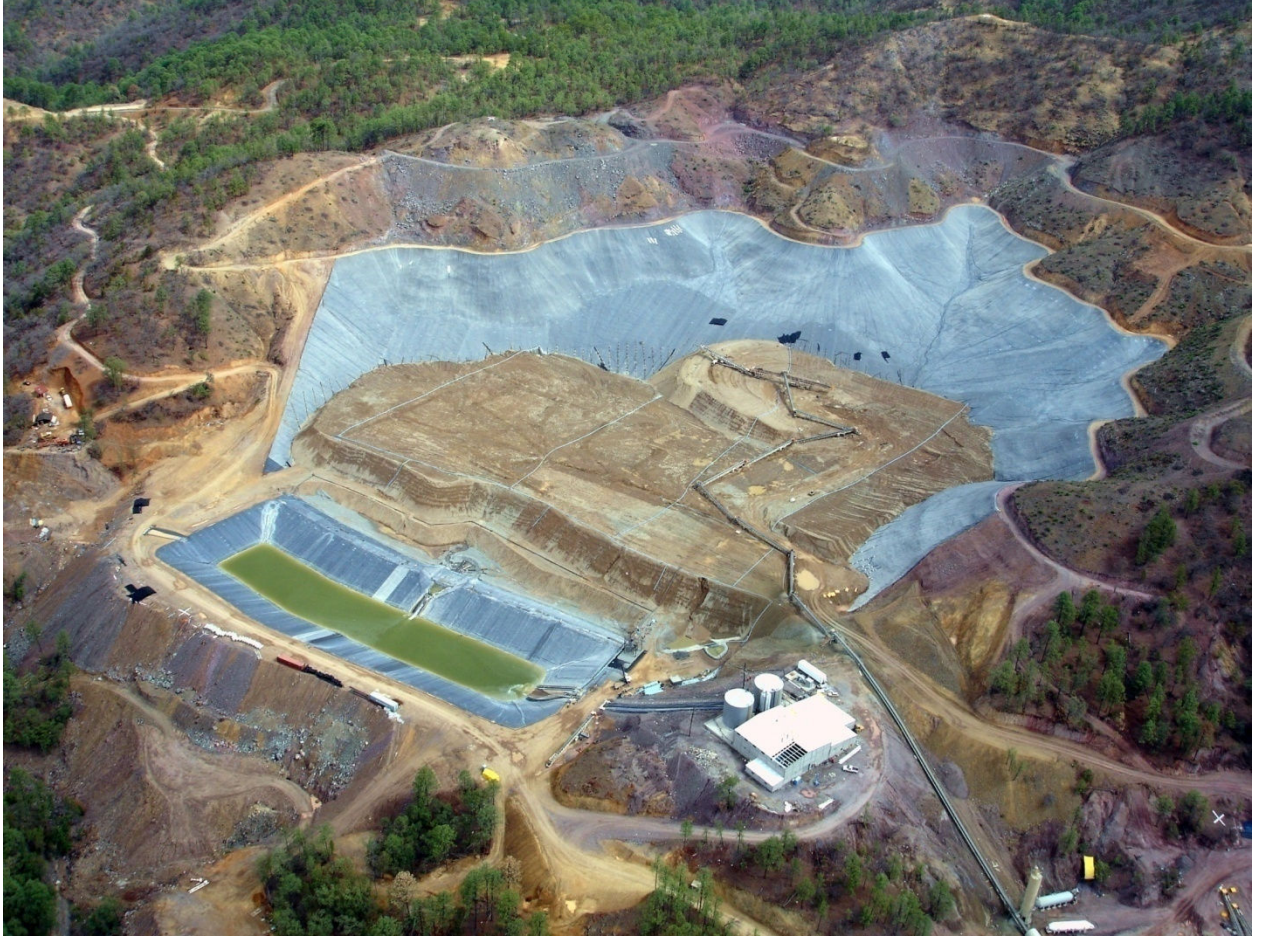
La foto muestra las pilas en las que se vierten la solución de cianuro de sodio y el material aurífero triturado. Gammon Lake, Ocampo. Foto del acervo de la Secretaría de Fomento Industrial del Gobierno Estado de Chihuahua.
