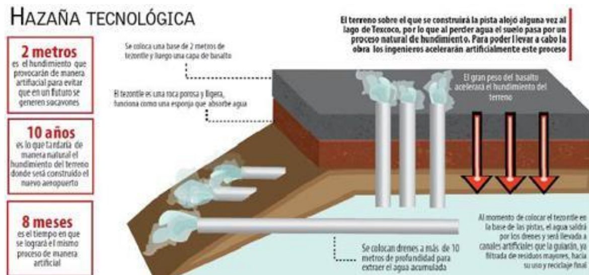
Ilustración 12. Esquema explicativo del funcionamiento de la técnica de precarga de suelos para estabilizar las arcillas del suelo del ex Lago de Texcoco. Fuente: Colegio de Ingenieros Civiles Mexicanos.
