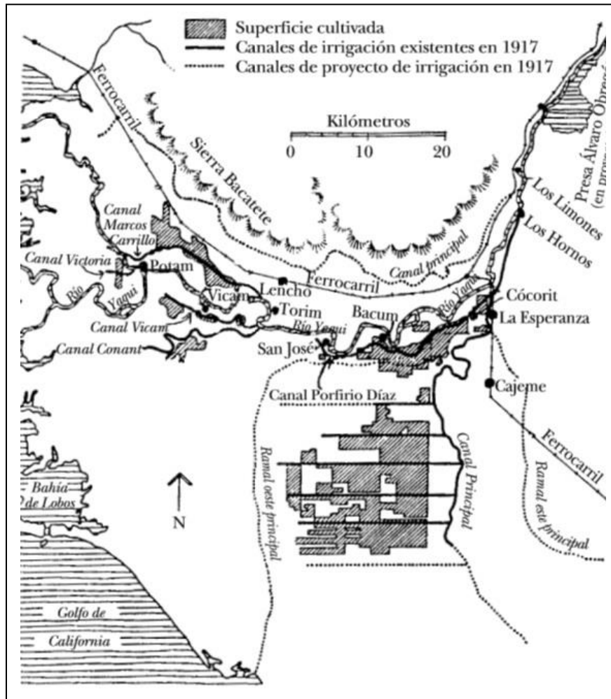
Mapa 3. Proyecto de irrigación de la Compañía Constructora Richardson S.A. en el Valle del Yaqui
