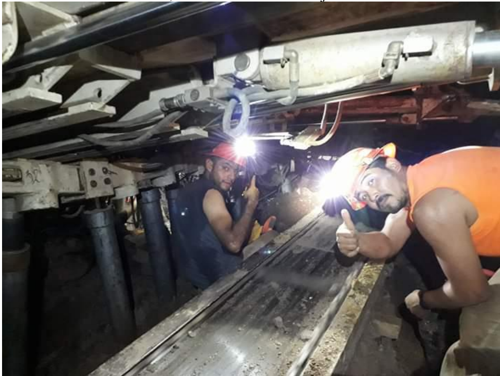
14. 'Rola' Alvizo (2019) Rola, Pedro y Ángel dentro de la mina 303 de MMB, operando la maquinaria del ademe caminante.
