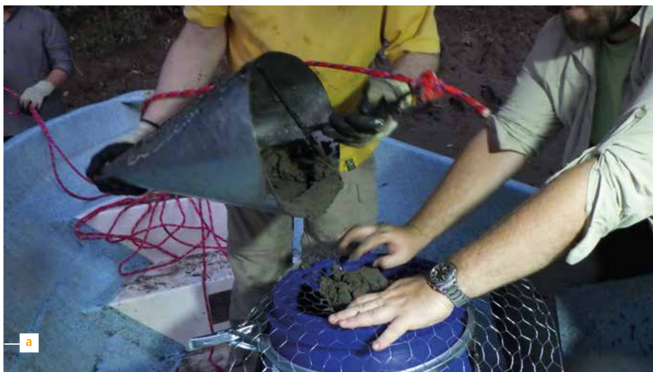
Figura 4.2: Muestreo manual de los sedimentos del Usumacinta: (a) con cono, (b) con pala, (c) con cubo. © I. Djeran-Maigre, abril 2018.
